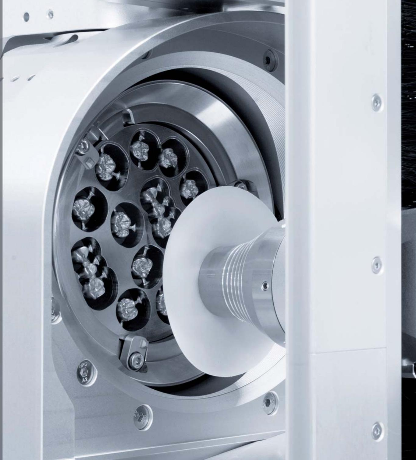
*Le Milling Spindle Hard Automatic permet l'élaboration de tous les matériaux doux et durs (en partie avec l'usinage par voie humide).*
