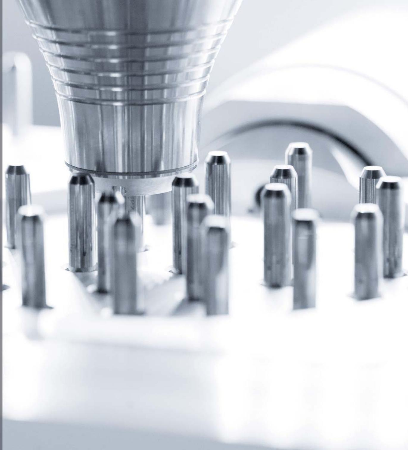
*Le Blank Changer intégré et la fonction de changeur d'outils automatique dans la fraiseuse M6 Wet Heavy Metal permettent le traitement jusqu'à 14 blocs dans un seul processus de fraisage et le remplacement jusqu'à 49 outils d'usinage.*
